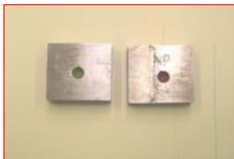
Calibro piatto da aggiustaggio per il controllo di forcelle
