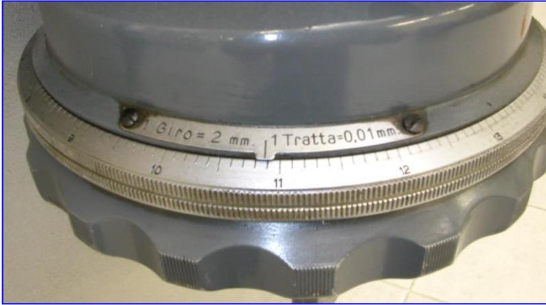
Girando a destra o a sinistra il micrometro inferiore, del proiettore di profili, si sposterà l'asse  $x$ , da un bordo all'altro dell'impronta, misurando, in tal modo, il secondo dei due diametri.
