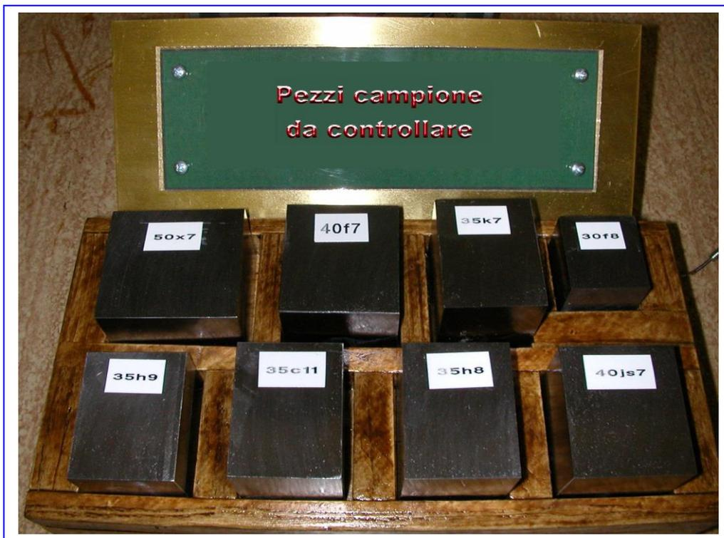
A tale proposito, nel Laboratorio Tecnologico, esiste una serie di pezzi campione, realizzati per l'esperienza. I pezzi 30f8, 35h9, 35c11 e 40js7 sono stati realizzati in tolleranza, i pezzi 40f7, 50x7, 35k7 sono stati realizzati fuori tolleranza ma recuperabili e il pezzo 35h8, è stato realizzato fuori tolleranza e non recuperabile.
